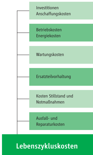
Abbildung 2: Lebenszykluskosten einer Kreiselpumpe
